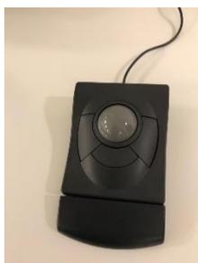
La **trackball QTRONIX** permette di muovere il puntatore ruotando la sfera di grande diametro posta al centro della base dello strumento.
